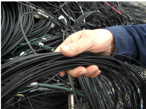
光ケーブルをある程度短く裁断する
