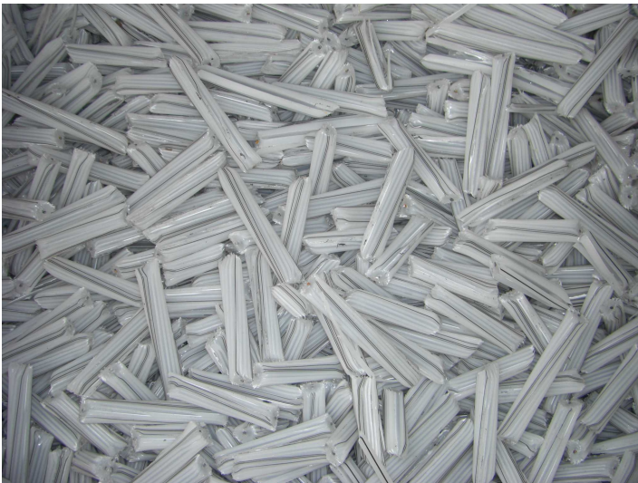
光ケーブルのスロット部
